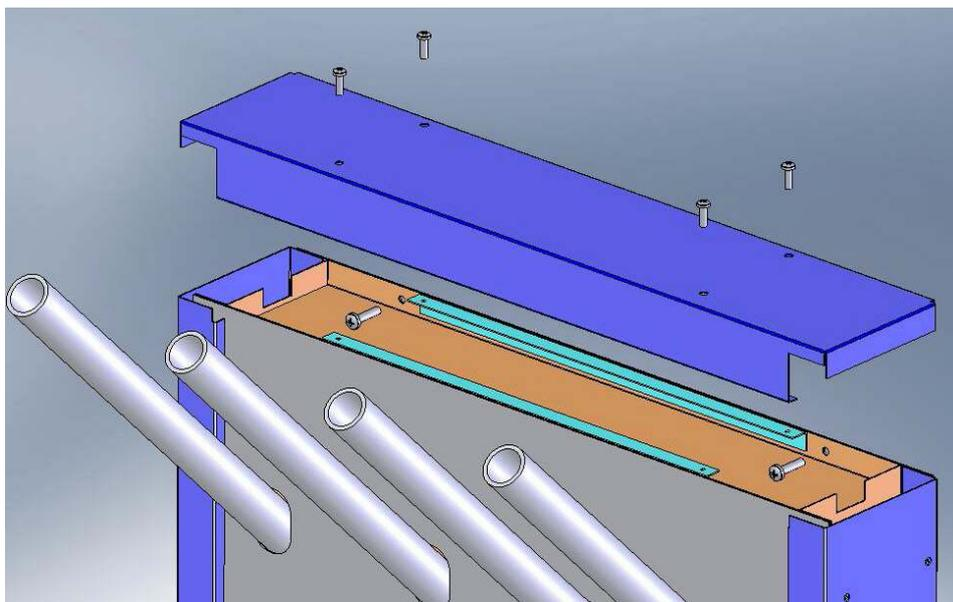
Рис. 7 Схема крепления сушильной панели к стене помещения
