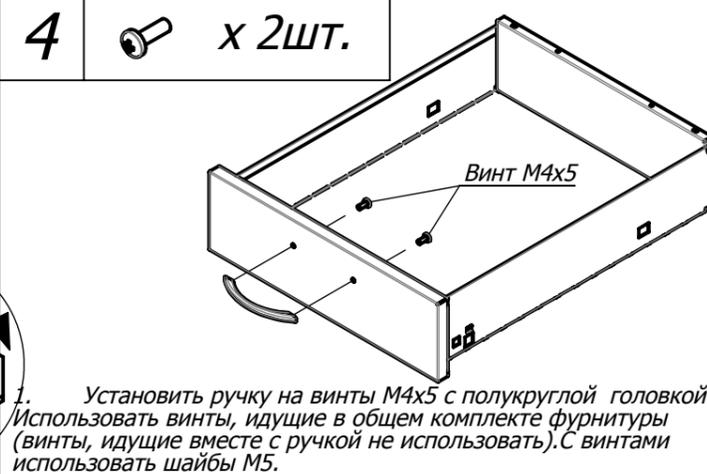
1. Установить ручку на винты М4х5 с полукруглой головкой. Использовать винты, идущие в общем комплекте фурнитуры (винты, идущие вместе с ручкой не использовать). С винтами использовать шайбы М5.
